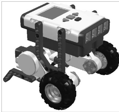
圖 D-9 差速驅動機器人完成
